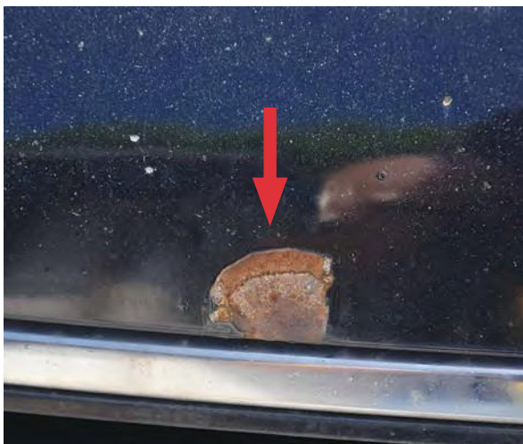
Големо оштетување од камчиња со знаци на 'рѓа
