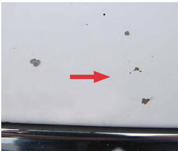
Прекумерно оштетување од камчиња на површина од 10 x 10 цм
