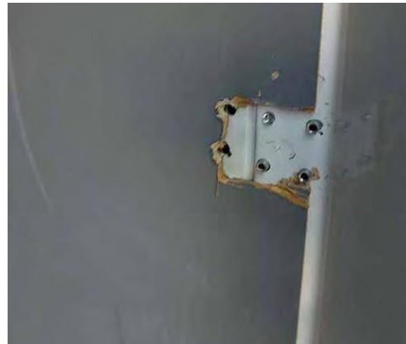
Видливи траги од демонтажа во товарниот простор
