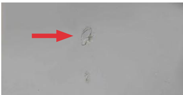
Лошо поправена штета од камчиња на ветробранското стакло
