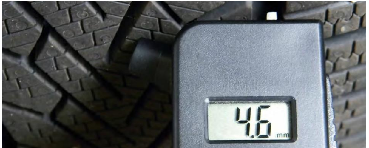
Длабочина на нагазен слој поголема од законски пропишаниот минимум
