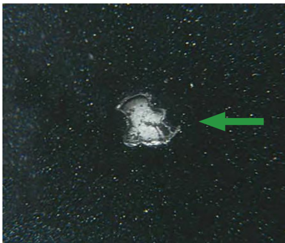
Оштетување од камчиња < 3 цм
