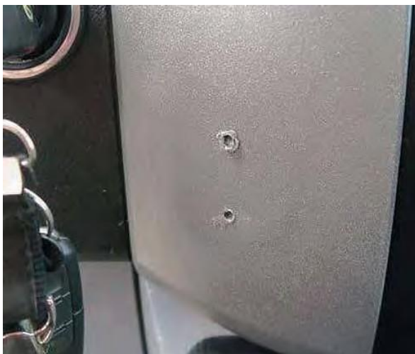
Продупчена инструментната табла
