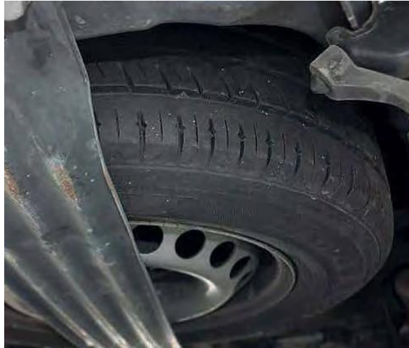
Резервно тркало монтирано под возилото
