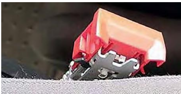
Оштетен завршеток на сигурносниот појас
