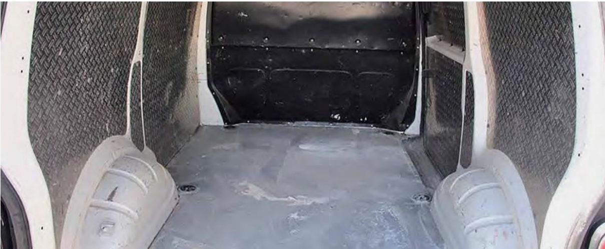
Неприфатливи траги од абење на товарниот простор
