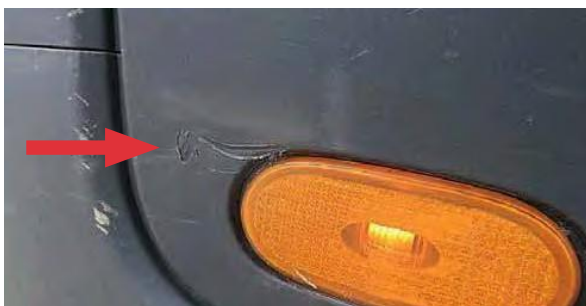
Голема гребнатина на пластичен дел
