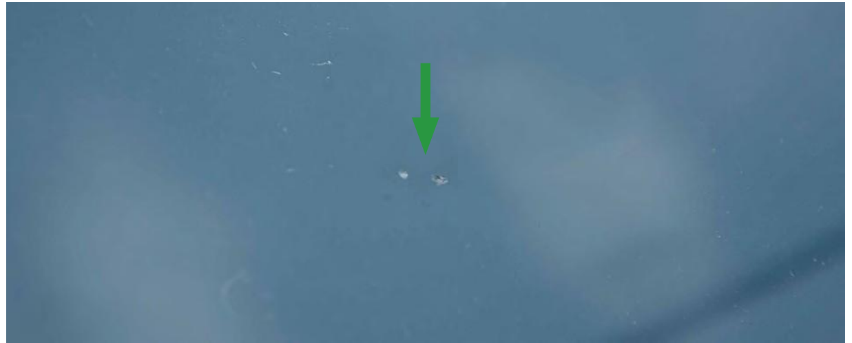
Мали оштетувања од камчиња на ветробранското стакло
