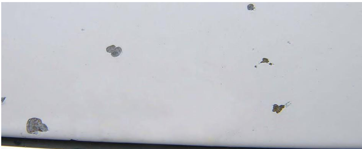
Повеќе оштетувања од камчиња на површина од 10 x 10 цм
