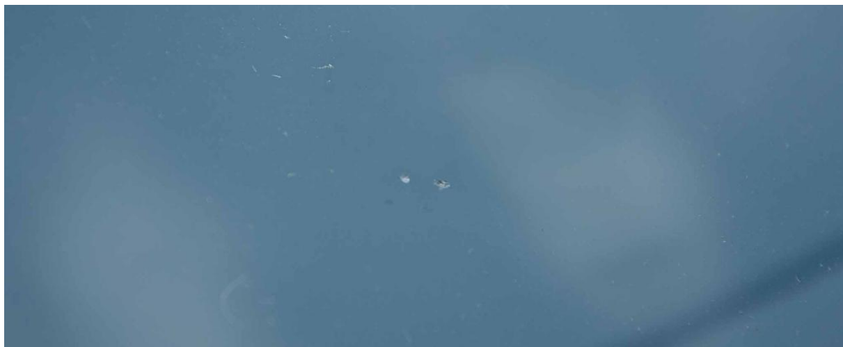
Мали оштетувања од камчиња на ветробранско стакло
