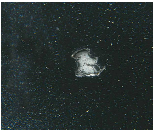
Оштетување од камче помало од 2 цм
